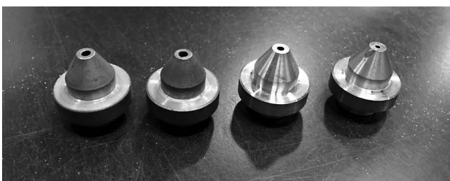
図4 交換式の先端で穴の径を調整（つくば）。
