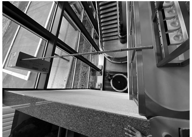
図5 吹き抜けで試作のY字振り子をテスト。 （上から撮影したもの）
